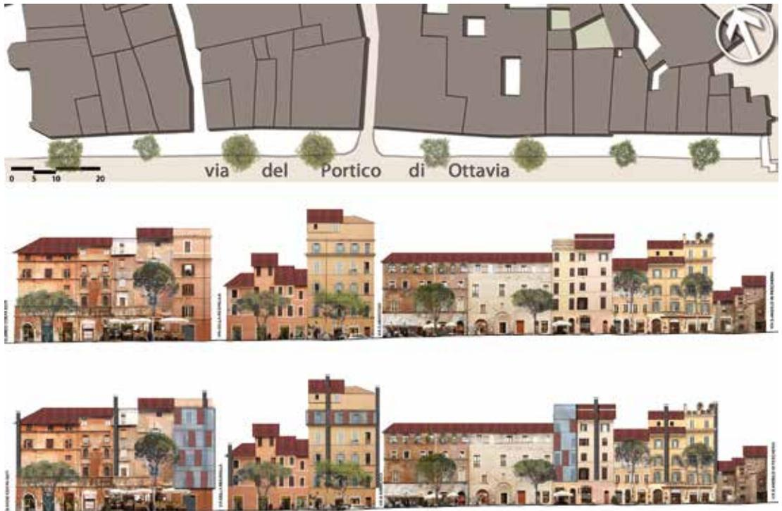
copertura, costituito da elementi preformati in rame contenenti un circuito con fluido vettore che accumula l'energia termica delle radiazioni solari trasferendola al sistema di riscaldamento degli edifici. La simulazione grafica dimostra la soddisfacente integrazione di questa tecnologia.
