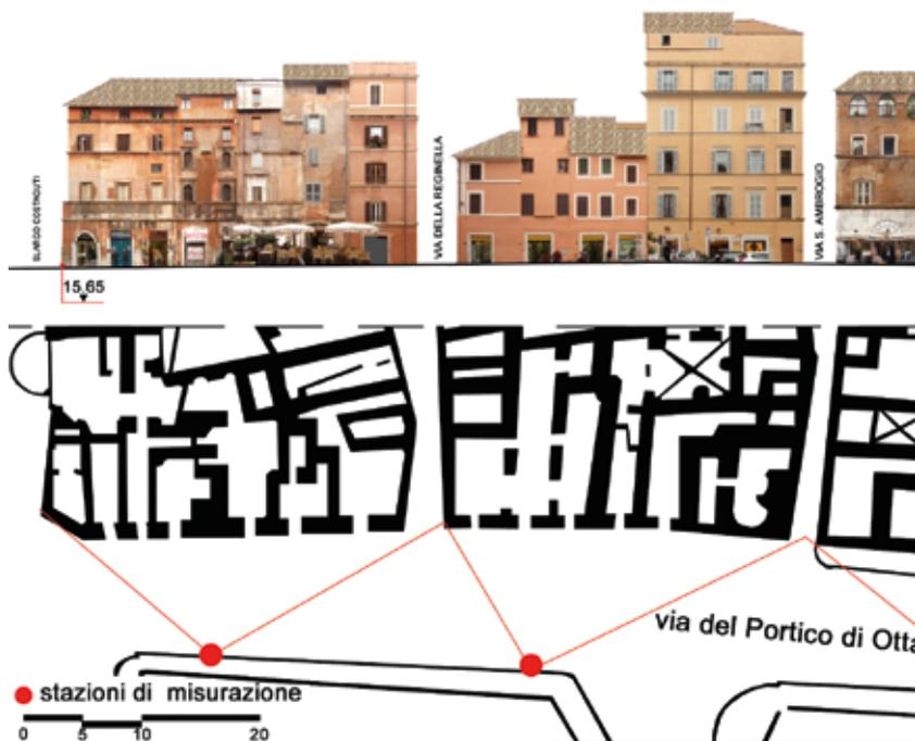
**Figura 19:** il profilo lungo via Del Portico di Ottavia, restituzione in fotopiano.
